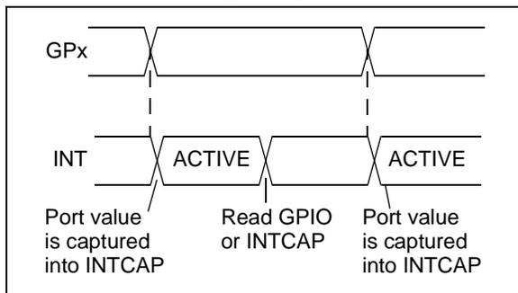
**FIGURE 1-7: INTERRUPT-ON-CHANGE FROM REGISTER DEFAULT**
