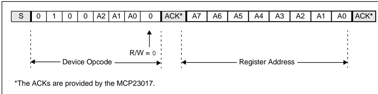
**FIGURE 1-5: SPI™ ADDRESSING REGISTERS**
