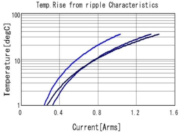
GCJ188R71H104KA12 Temp. rise ■ 400kHz ■ 800kHz ■ 1MHz
