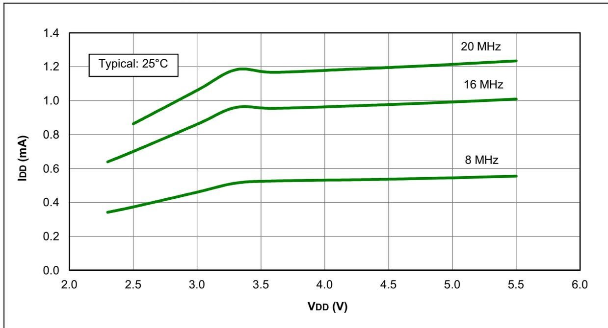
**FIGURE 30-18: I<sub>DD</sub> MAXIMUM, EXTERNAL CLOCK (ECH), HIGH-POWER MODE, PIC16F1508/9 ONLY**
