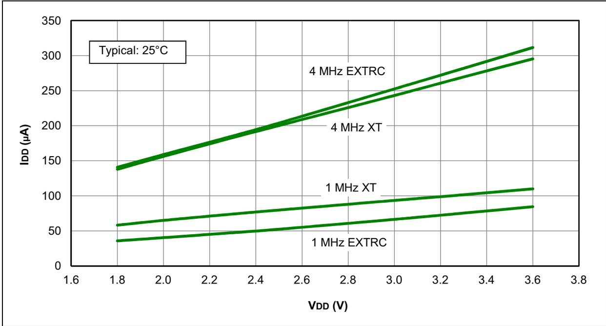
**FIGURE 30-4: I<sub>DD</sub> MAXIMUM, XT AND EXTRC OSCILLATOR, PIC16LF1508/9 ONLY**
