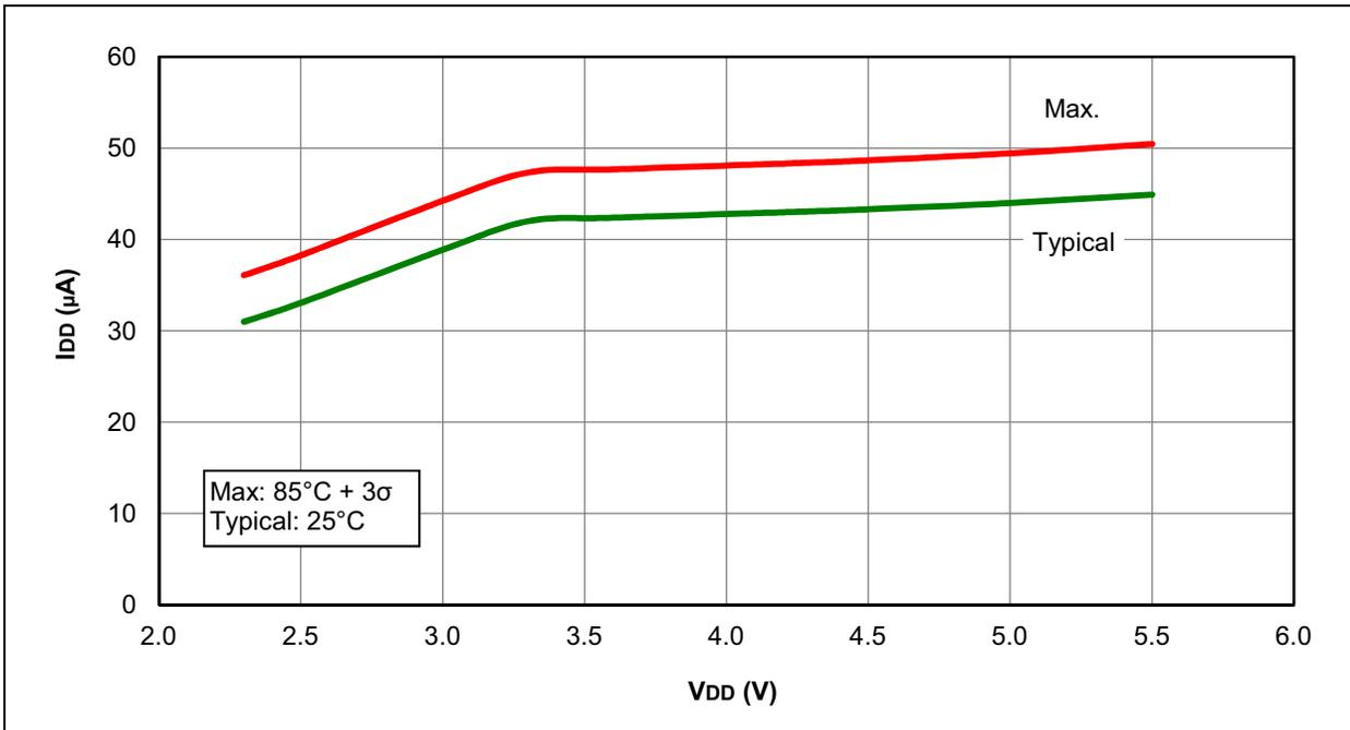
**FIGURE 30-11: I<sub>DD</sub> TYPICAL, EXTERNAL CLOCK (ECM), MEDIUM-POWER MODE, PIC16LF1508/9 ONLY**
