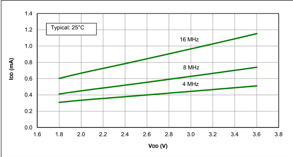
**FIGURE 30-24: I<sub>DD</sub> MAXIMUM, HFINTOSC, PIC16LF1508/9 ONLY**
