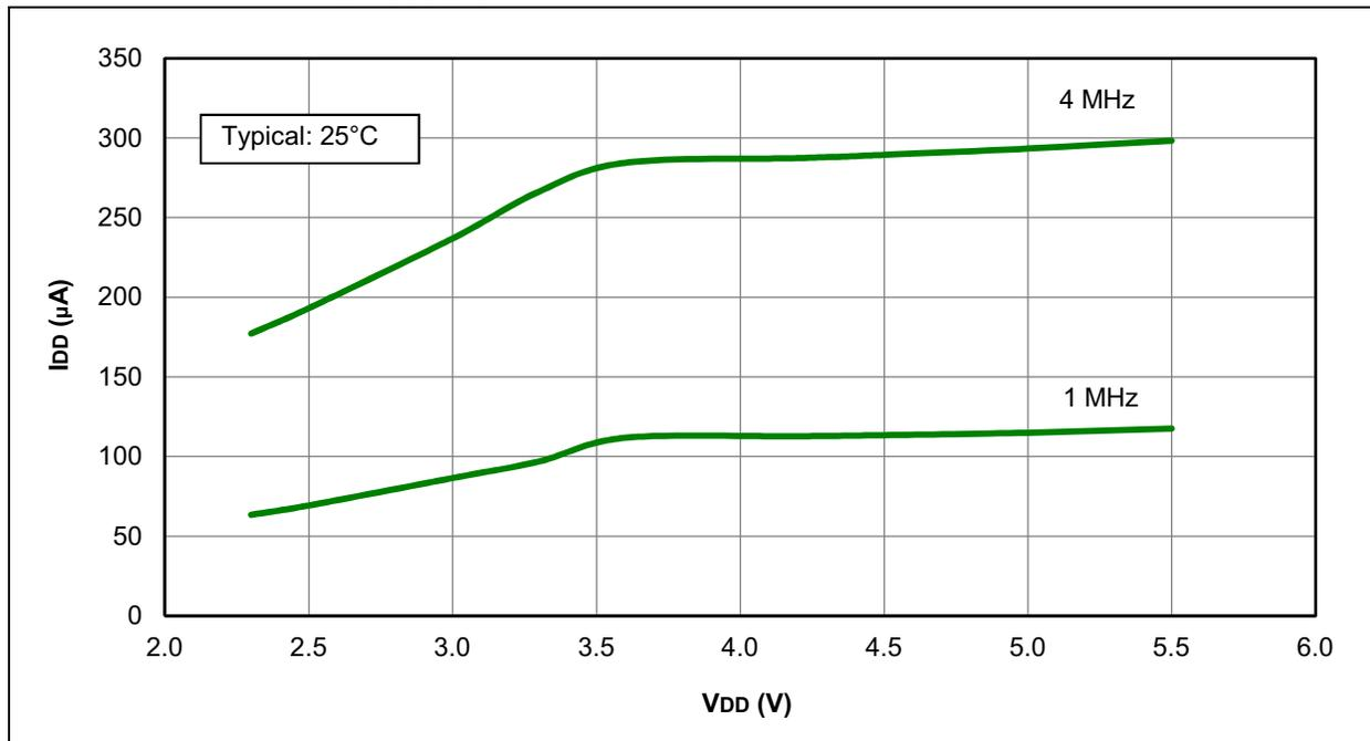
**FIGURE 30-14: I<sub>DD</sub> MAXIMUM, EXTERNAL CLOCK (ECM), MEDIUM-POWER MODE, PIC16F1508/9 ONLY**
