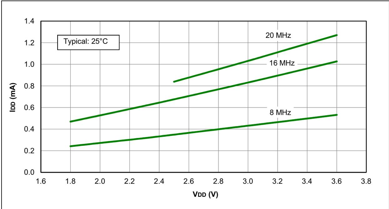
**FIGURE 30-16: I<sub>DD</sub> MAXIMUM, EXTERNAL CLOCK (ECH), HIGH-POWER MODE, PIC16LF1508/9 ONLY**
