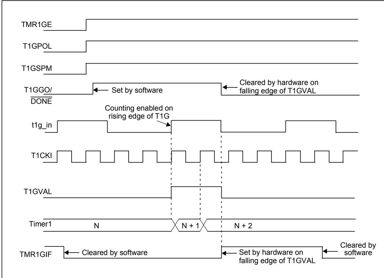
**FIGURE 19-6: TIMER1 GATE SINGLE-PULSE AND TOGGLE COMBINED MODE**
