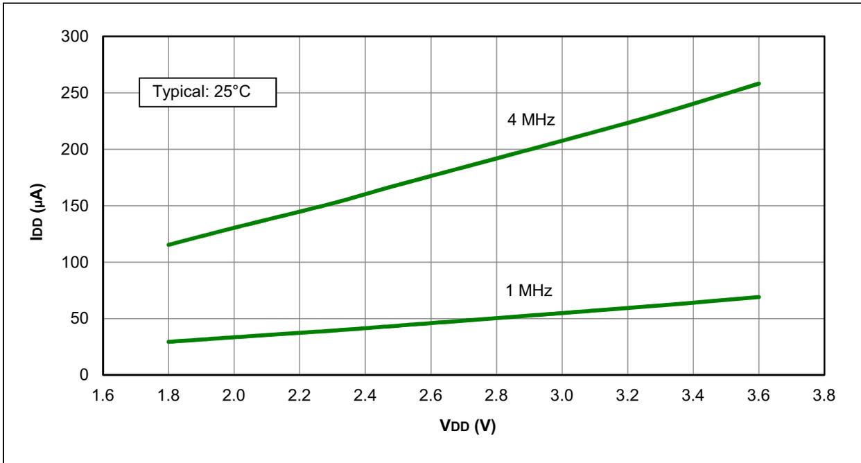
**FIGURE 30-12: I<sub>DD</sub> MAXIMUM, EXTERNAL CLOCK (ECM), MEDIUM-POWER MODE, PIC16LF1508/9 ONLY**
