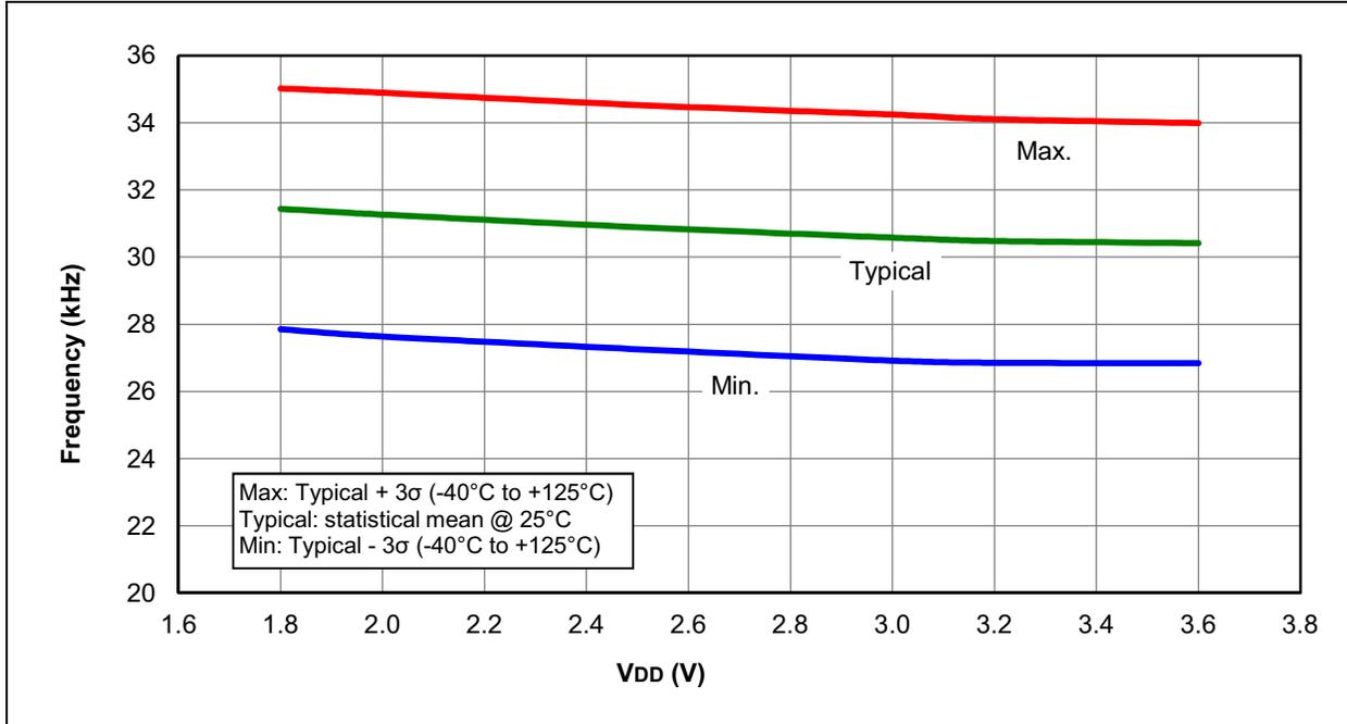
**FIGURE 30-71: LFINTOSC FREQUENCY OVER V<sub>DD</sub> AND TEMPERATURE, PIC16F1508/9 ONLY**
