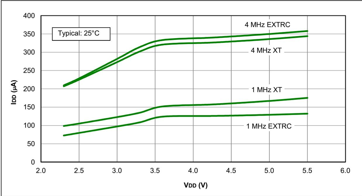
FIGURE 30-6: I<sub>DD</sub> MAXIMUM, XT AND EXTRC OSCILLATOR, PIC16F1508/9 ONLY
