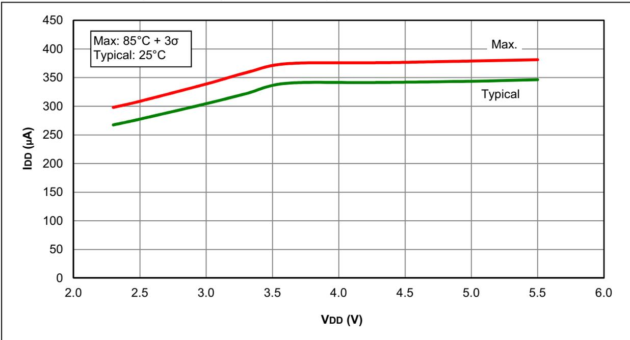
**FIGURE 30-23: I<sub>DD</sub> TYPICAL, HFINTOSC, PIC16LF1508/9 ONLY**
