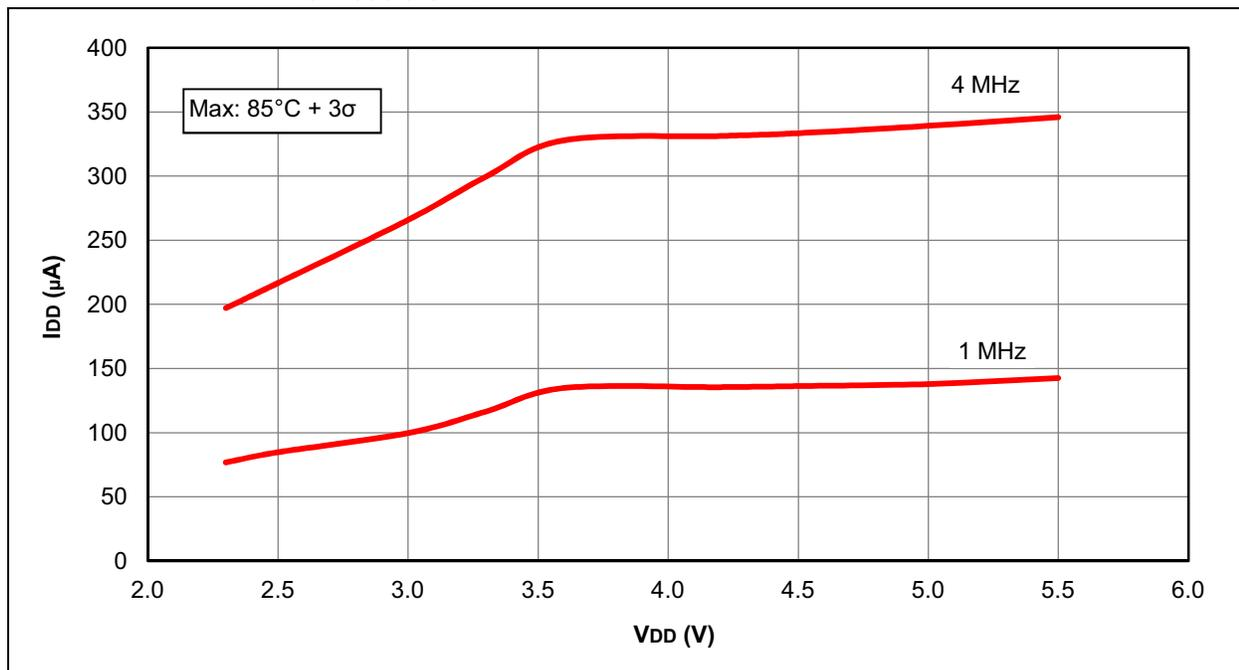
**FIGURE 30-15: I<sub>DD</sub> TYPICAL, EXTERNAL CLOCK (ECH), HIGH-POWER MODE, PIC16LF1508/9 ONLY**
