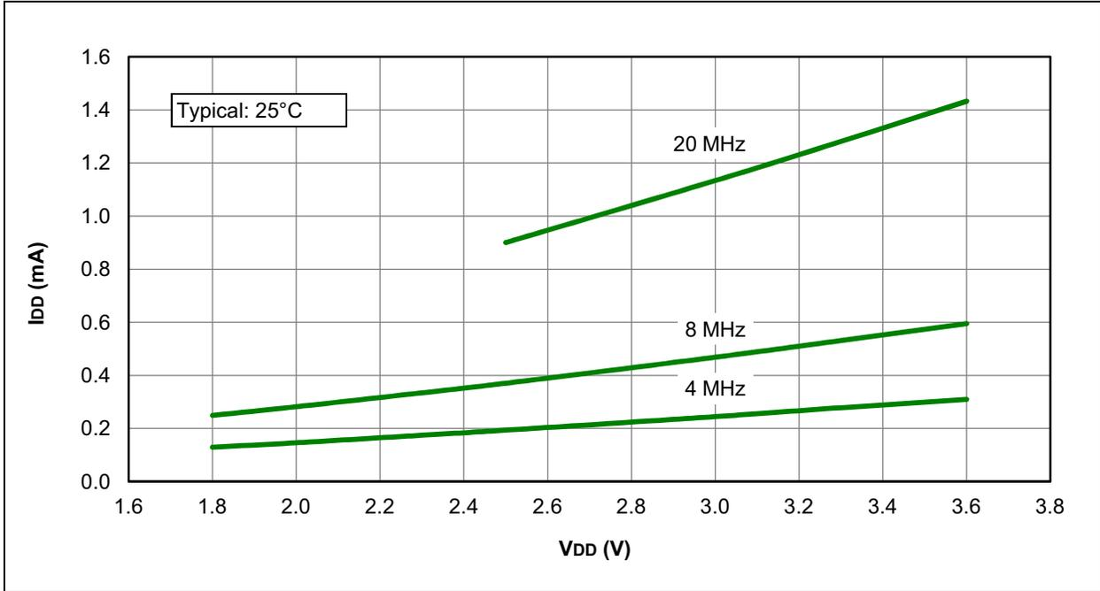
**FIGURE 30-28: I<sub>DD</sub> MAXIMUM, HS OSCILLATOR, PIC16LF1508/9 ONLY**
