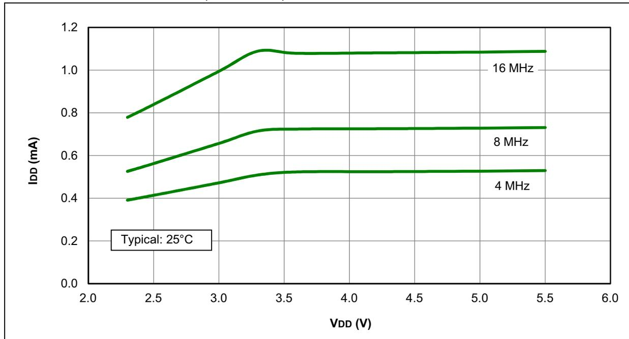
FIGURE 30-26: I<sub>DD</sub> MAXIMUM, HFINTOSC, PIC16F1508/9 ONLY
