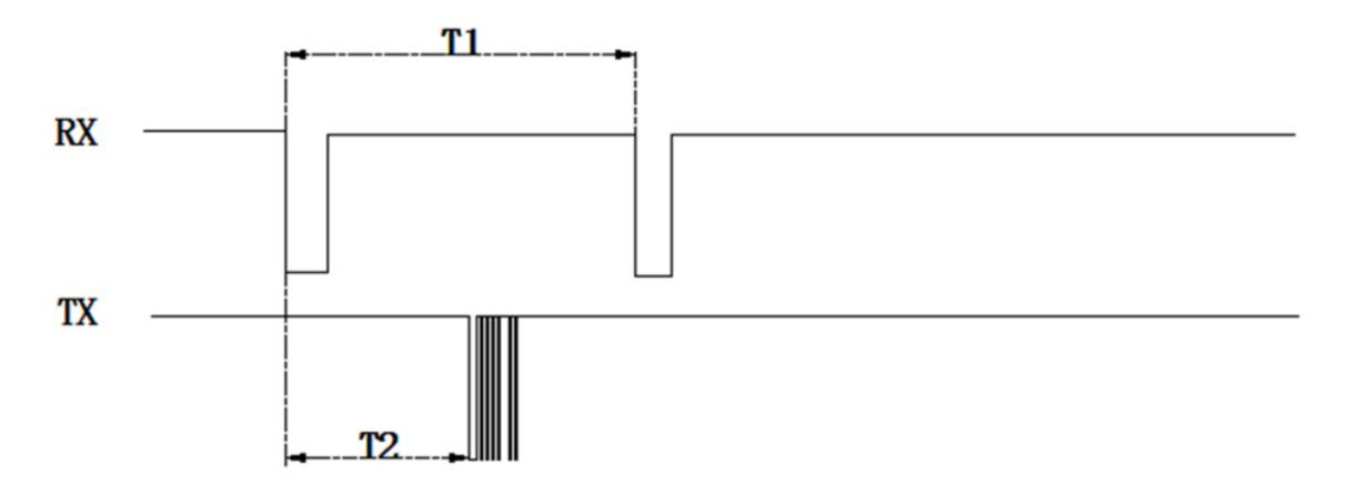
Remark: A08A module: T1 >100ms; T2=75 $\sim$ 90ms
